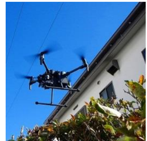
UAVsを活用した外壁点検業務
